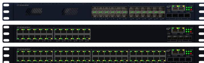
Коммутаторы поддерживают весь необходимый функционал для построения маршрутизируемых, надежных и масштабируемых сетей. Устройство обеспечивает работу протоколов динамической маршрутизации RIP и OSPF, что позволяет использовать эти коммутаторы для построения ядра корпоративной сети.
